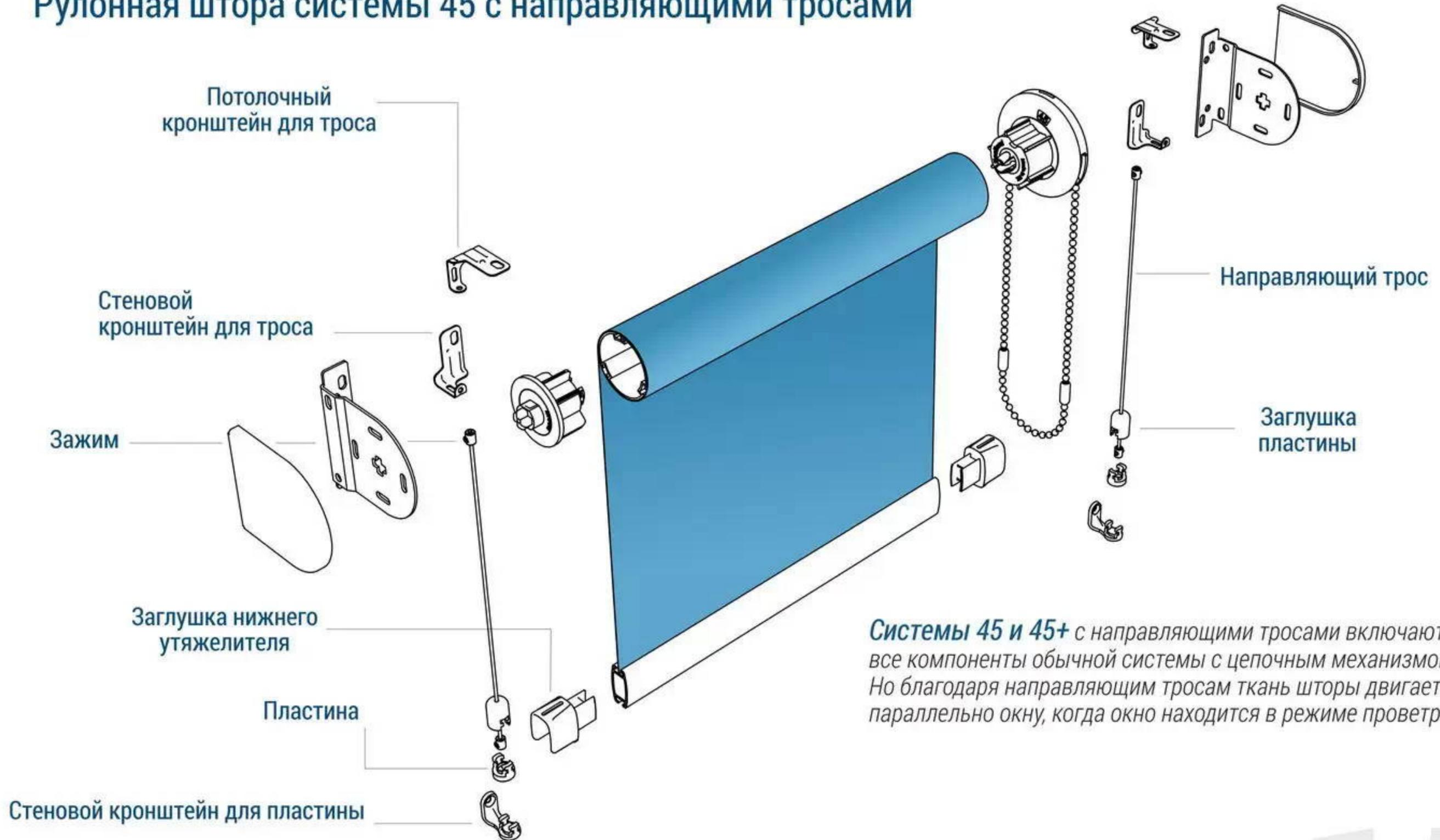
*Системы 45 и 45+ с направляющими тросами включают в себя все компоненты обычной системы с цепочным механизмом. Но благодаря направляющим тросам ткань шторы движется параллельно окну, когда окно находится в режиме проветривания.*
